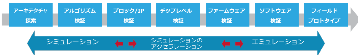
図5：Palladium Z1プラットフォームが提供する強化された統合フローにより、ユーザーはシミュレーション、シミュレーションのアクセラレーション、エミュレーションの間を移動して、優れたパフォーマンスと強力なデバッグが可能。
